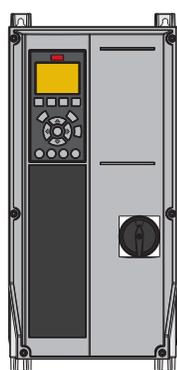
带主电源断路开关的 A4 IP 55
